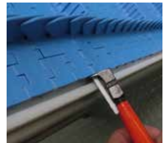
4 ベルトエッジの後ろから突き出すロッドの端を切ってください。
